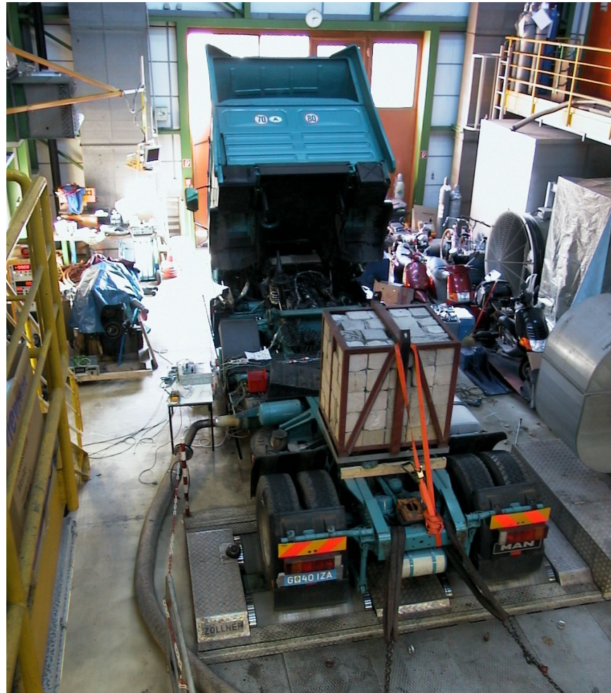
Rollenprüfstand für Schwere Nutzfahrzeuge der TU-Graz
